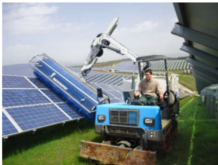
Fotografia 4.6 – Exemplo do equipamento para limpeza dos painéis fotovoltaicos
